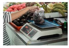
Verifica Periodica strumenti di pesatura NAWI BILANCE NON AUTOMATICHE SCADENZE TRIENNALI
